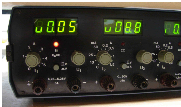
Bild 37: U1 abgeschaltet (Überlast ?)
