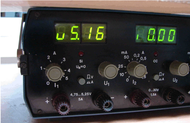
Bild 36: U1 eingeschaltet, Spannung wird angezeigt
