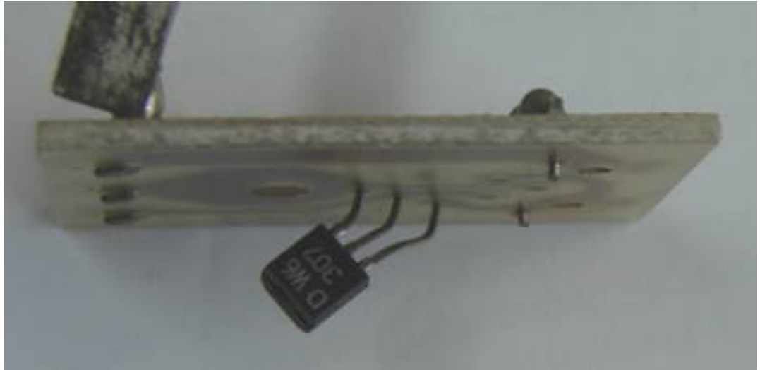
Bild 14: ein SC307 als Temperaturfühler
