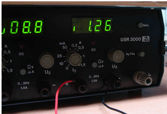
Bild 35: U 3 im Konstantspannungs-Modus, Strom wird angezeigt
