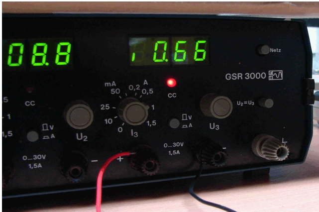
Bild 34: U 3 im Konstantstrom-Modus, Strom wird angezeigt
